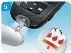
5 Toccare con l'estremità gialla della striscia reattiva la goccia di sangue. Non applicare il sangue sulla parte superiore della striscia reattiva. Allontanare il dito dalla zona reattiva non appena il messaggio **Test in corso** appare sul display.
